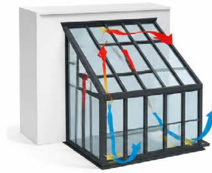
Dach- oder Firstlüftung: Zur Entlüftung stehen Dachlüftungskappen oder Walzenlüfter zur Verfügung. Zuluft kommt über Fenster, Türen oder Schiebelüfter.
